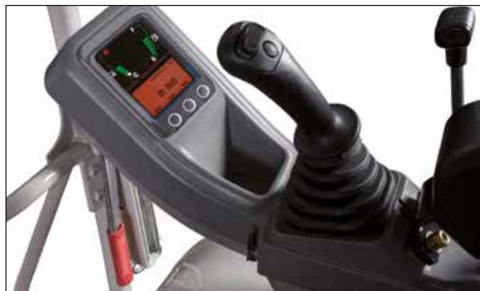
Panel de control con avisos acústicos y visuales; dirección proporcional del 2º circuito hidráulico desde el joystick derecho.
