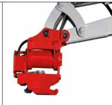
Powerlift con enganche rápido hidráulico o mecánico
