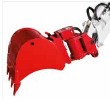
Powerlift con enganche rápido hidráulico, cazo montado al revés
